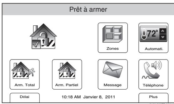
1. Appuyez sur l'icône Arm. Partiel, le système émet un bip et affiche un clavier.
