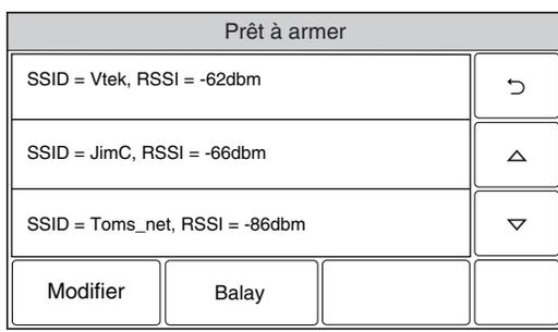
3. Sélectionnez le réseau désiré et sélectionnez ensuite le bouton « Modifier ». L'information sur le réseau est affichée. Si un mot de passe est requis, sélectionnez le bouton « Clé » et entrez le mot de passe.
