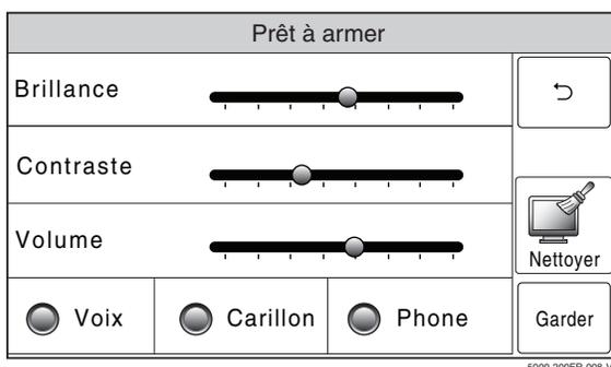
2. Sélectionnez l'icône « Voix ». Le système commute entre « EN » et « HORS ». Quand « Activé » est sélectionné, le mode vocal est actif.
