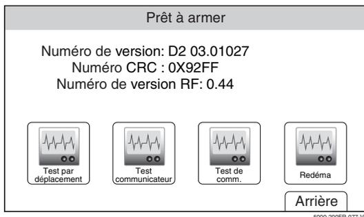
4. Sélectionnez l'icône « Test par déplacement » ou « Redémar » » Si le test par déplacement est sélectionné, passez à l'étape 5. Si le test du communicateur est sélectionné, passez à l'étape 6. Si le redémarrage est sélectionné, passez à l'étape 7.
