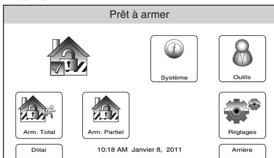
**Note :** Pour régler la date et l'heure, le système doit être désarmé.
