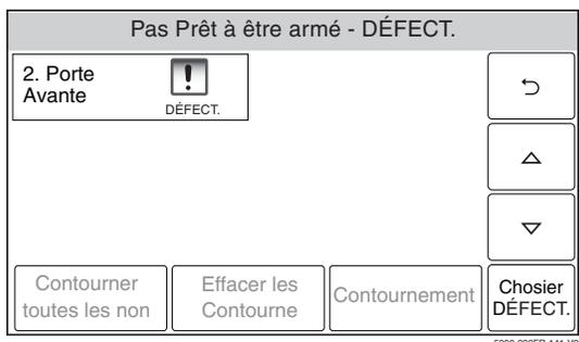
2. Sélectionnez la ou les zones que vous voulez contourner et sélectionnez « Zones » OU, si cette fonction est programmée, appuyez sur le bouton « Contourner toutes les non prêtes » (excepté les zones d'urgence, les zones d'incendie et les zones CO). Le système affiche un clavier.
