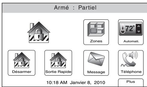
1. Appuyez sur l'icône « Sortie rapide » pour redémarrer le délai de sortie.
