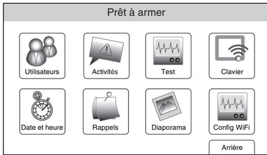
3. Sélectionnez l'icône « Test ». Le système affiche l'écran de Test.
