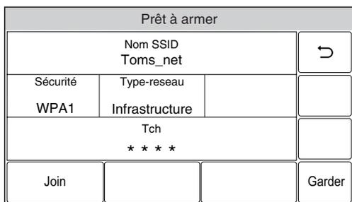
3. Sélectionnez le bouton « Nom SSID » et entrez le nom du réseau sur le clavier qui est affiché.
